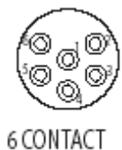
Figure 9 Konfigurace kontaktů (připojení k sondě C-7)
